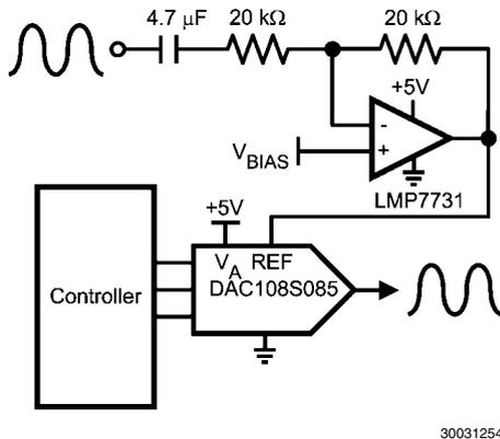
FIGURE 16. Programmable Attenuator
